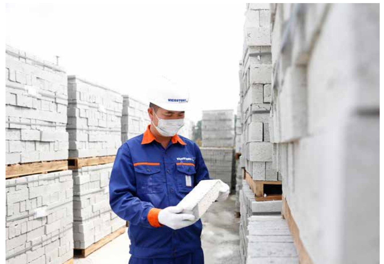
Bùn thải được sử dụng làm nguyên liệu để sản xuất gạch không nung
