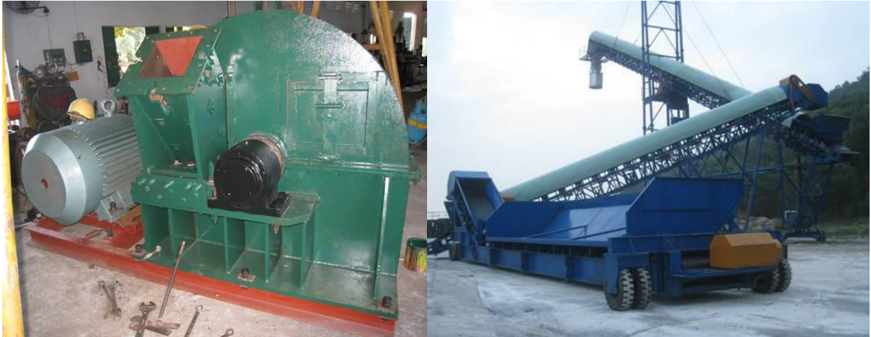
(Máy băm gỗ và các hệ thống băng tải gỗ đã băm)
