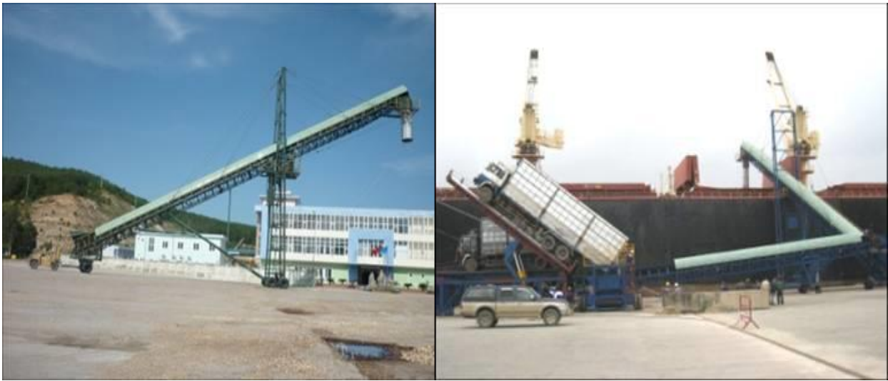
(Băng tải chuyển dăm gỗ lên tàu và hệ sàn nâng băng tải chuyển dăm lên tàu năng suất 400-500tán/h)
