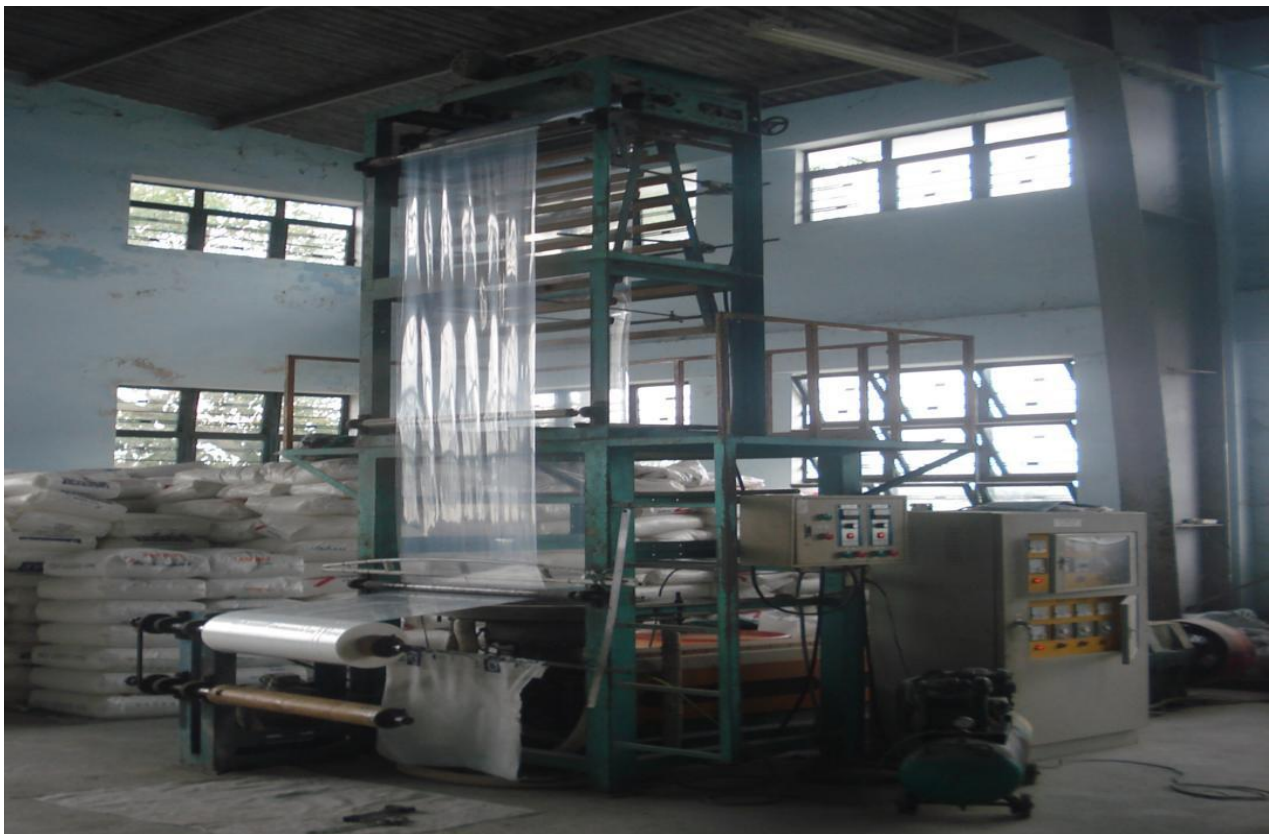
(Dây chuyền sản xuất bao bì PP, PE)
