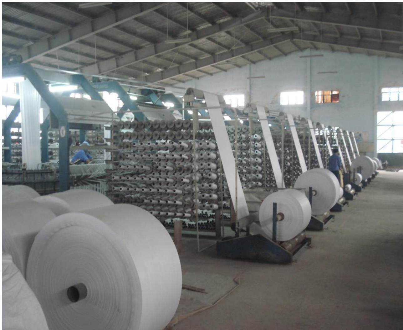
(Dây chuyền sản xuất bao bì PP, PE)
