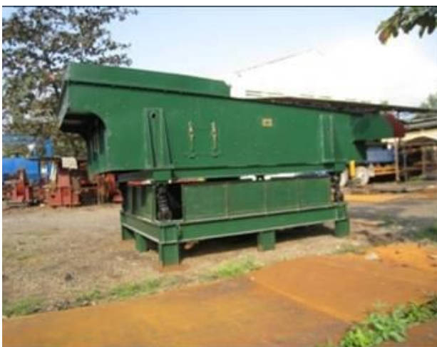
(Máy sàng dăm gỗ năng suất 25-45 tấn/h và băng tải chuyên dăm gỗ ra bãi)
