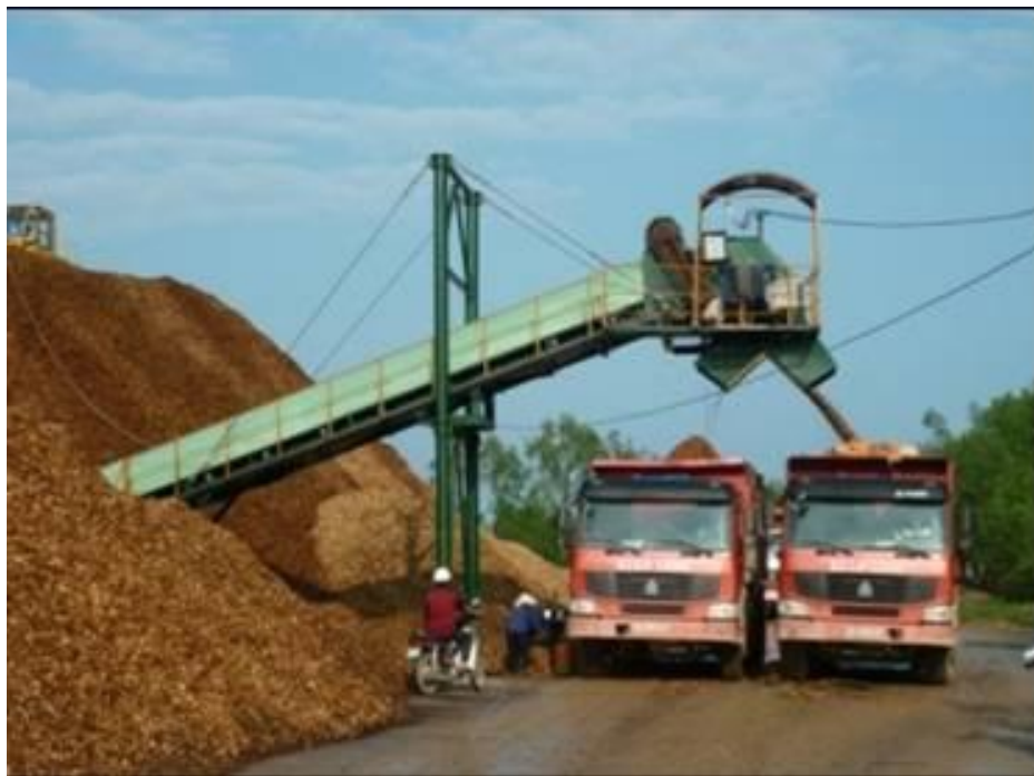
(Hệ thống băng tải di động 2 vòi chuyển dăm gỗ lên ô tô)
