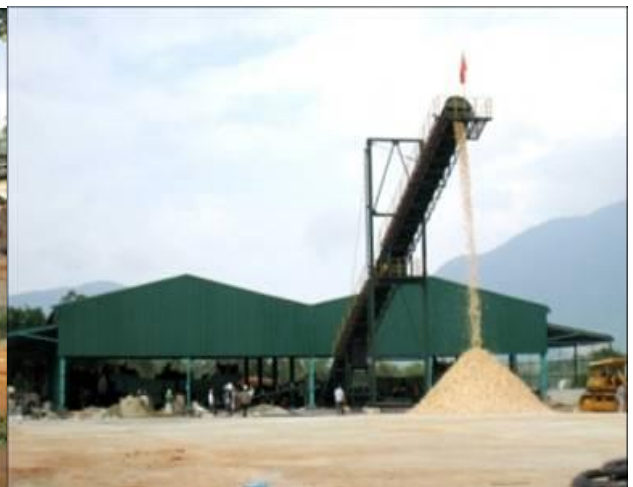
(Máy sàng dăm gỗ năng suất 25-45 tấn/h và băng tải chuyên dăm gỗ ra bãi)
