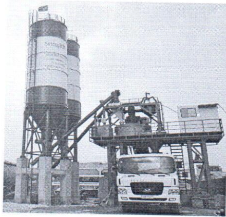
Trạm trộn BT 45m 3 /giờ + xe bơm + bơm tĩnh + phụ kiện
