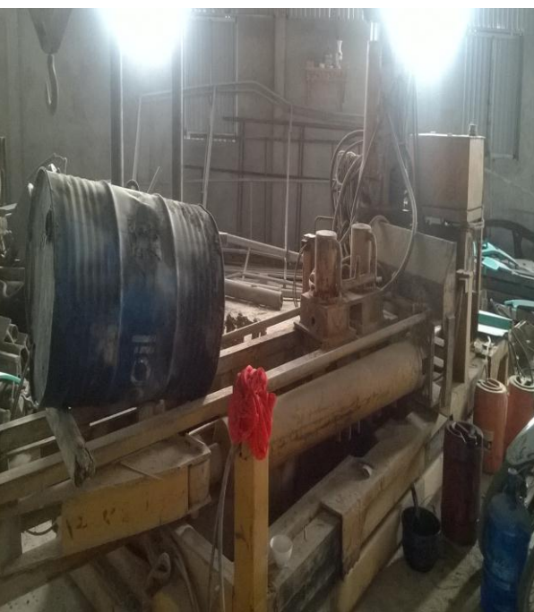
MÁY ÉP CỌC BÊ TÔNG
