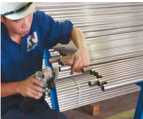
Hình 3: Công nhân mài đầu ống
