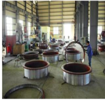
Khớp lắp ráp bơm 36.000 m 3 /h
