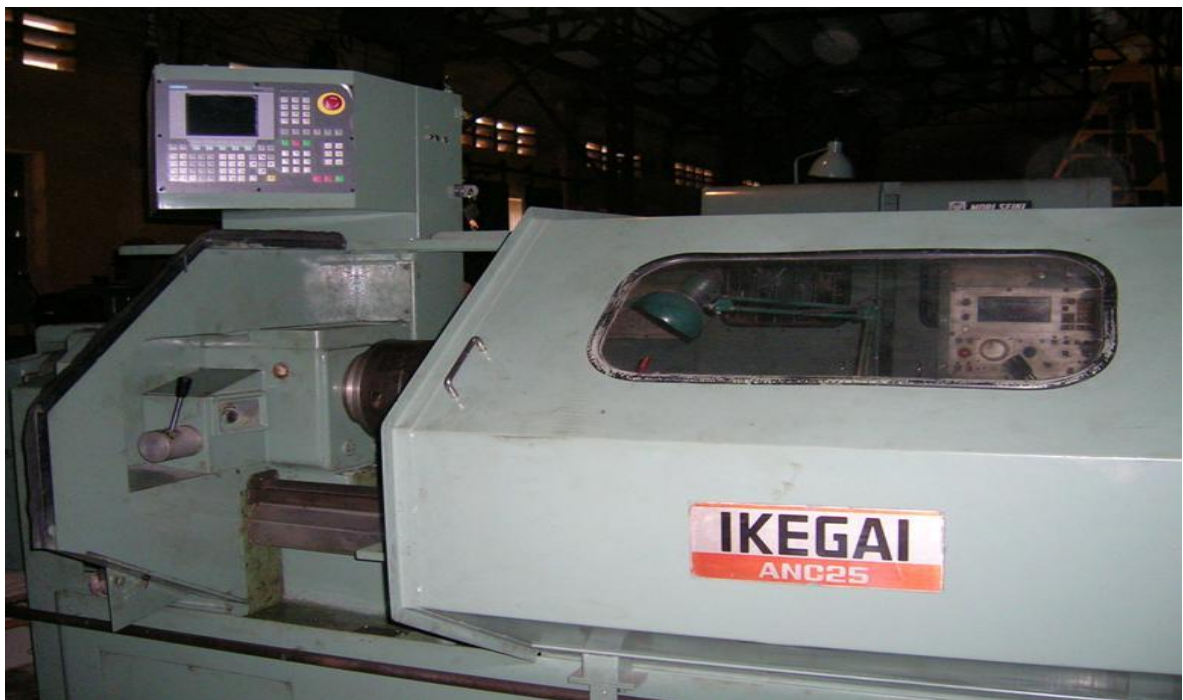
Ảnh: Máy tiện được nâng cấp bằng bộ điều khiển CNC của SIEMENS.
