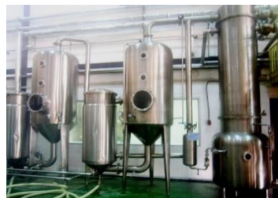
Hệ thống cô Song hiệu giảm áp, công suất cao
