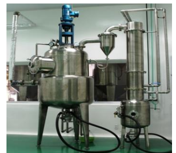
Hệ thống cô giảm áp, công suất cao
