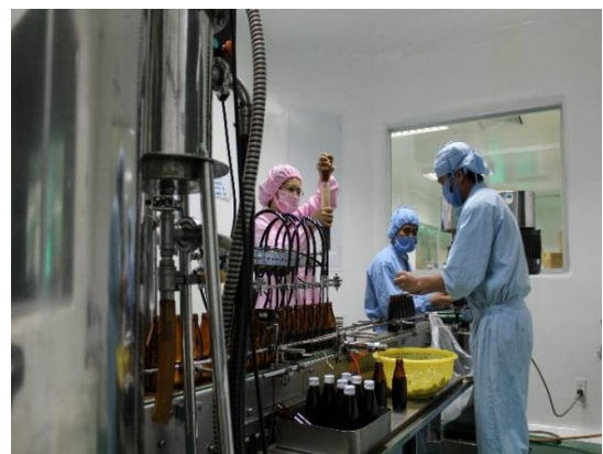
Hệ thống chiết chai chân không
