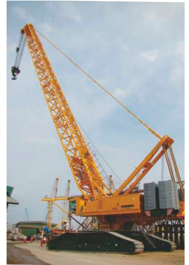
(Nghiệm thu và bàn giao cầu bánh xích LR 11350 - CRAWLER CRANE LR 11350 cho Liên doanh Dầu khí Việt Nga Vietsovpetro)
