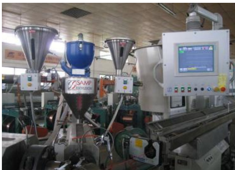
Dây chuyền bện, kéo và bọc sợi đồng
