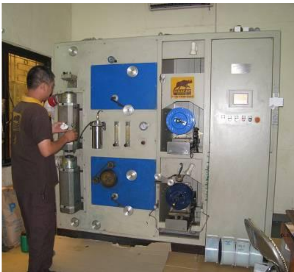
Dây chuyền nhuộm màu sợi cáp – Một bộ phận của hệ thống sản xuất cáp quang
