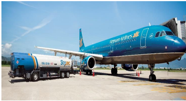
HÌNH 6: Tra nạp xăng Jet-A1 bằng xe
