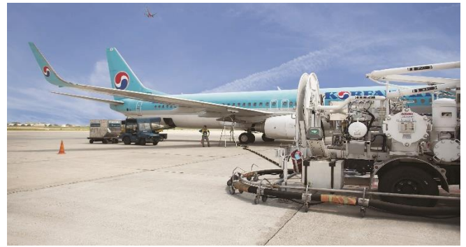
HÌNH 7: Tra nạp qua hệ thống tra nạp ngầm
