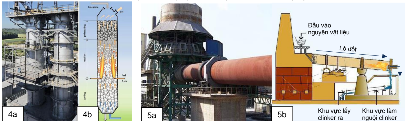
Ảnh 4 & 5: Quy trình sản xuất xi măng theo công nghệ lò đứng (4a & 4b) và công nghệ lò quay khô (5a & 5b)
