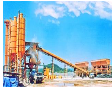
Trạm trộn Bê tông đầm lăn IMI Công suất : 120m3/h
